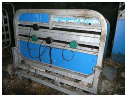
Cellules optiques déplaçables qui déclenchent la fermeture
