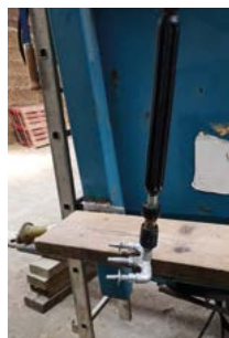
Le trident est fixé sur la lance du nettoyeur haute pression.
